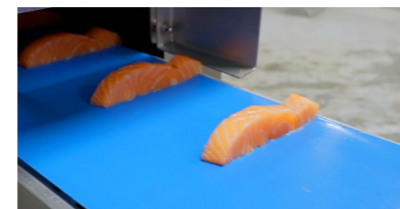
El filete es cortado en porciones precisas y luego entra en una segunda máquina donde se las cortan en dados.
