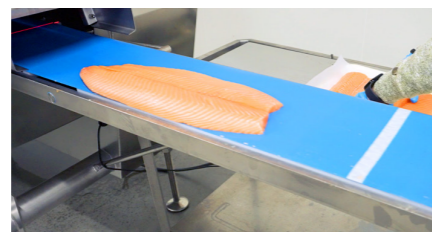
Ein Filet wird auf dem Einlaufband der Maschine platziert
