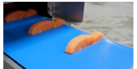
필레는 먼저 정밀한 조각으로 커팅된 다음 두 번째 단계에 진입하여 큐브 형태로 커팅됩니다
