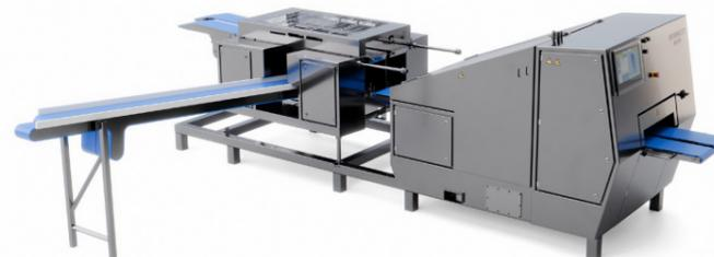
L'égaliseur Borncut régule le flux vers le processus en aval et permet de réaliser des coupes plus difficiles et des applications par lots.
