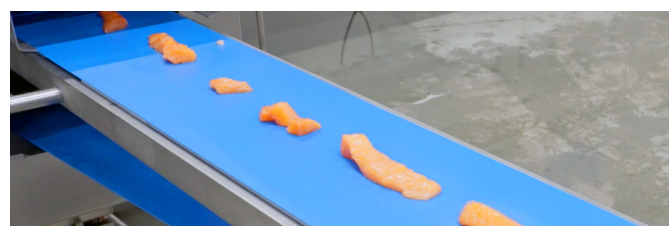
แซลมอนที่หันเป็นลูกเต๋าชิ้นเล็กพอดีคำถูกลำเลียงออกมาจากตัวเครื่อง
