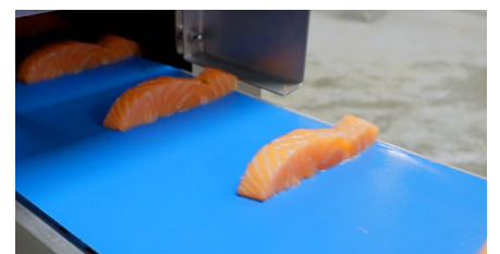
หันเนื้อปลาให้เป็นชิ้นเล็กลงอย่างแม่นยำก่อน จากนั้นจึงเข้าสู่ขั้นตอนที่สองซึ่งจะต้องหันเนื้อปลาให้เป็นลูกเต๋า
